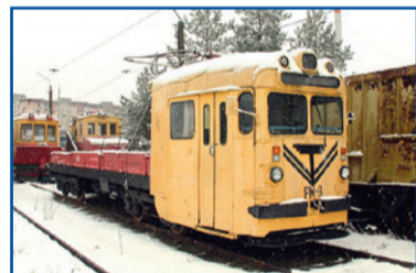
г. Нижний Новгород, служебный вагон на базе МТВ-82
