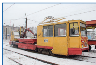
г. Нижний Новгород, вагон-экскаватор на базе КТМ-5
