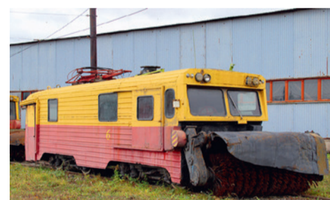
г. Магнитогорск, вагон-снегоочиститель на базе МТВ-82
