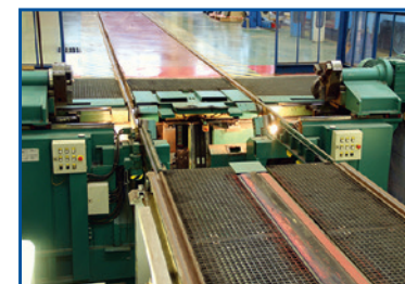
Станок обточки колёсных пар в Краснопресненском депо.
